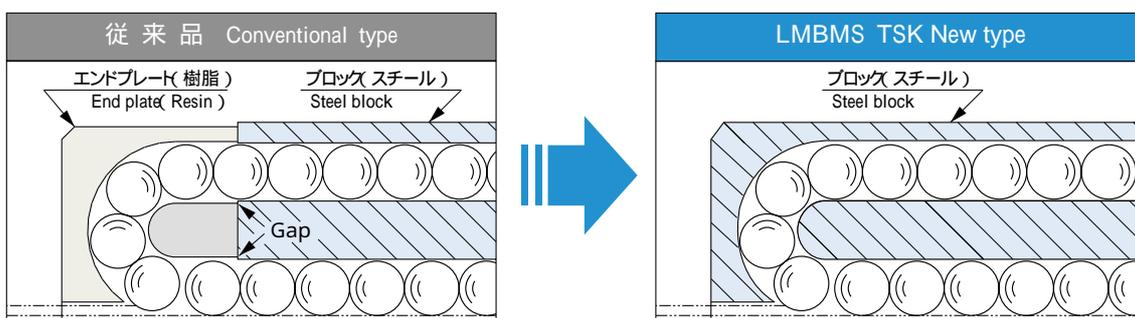
**世界初、エンドプレート無し一体構造型開発成功！！ 世界最速！！**
